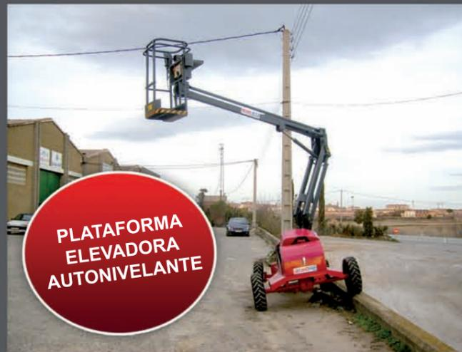
La capacidad de autonivelación del modelo AV550 hacen fácil el acceso a las zonas con un firme en desnivel.
